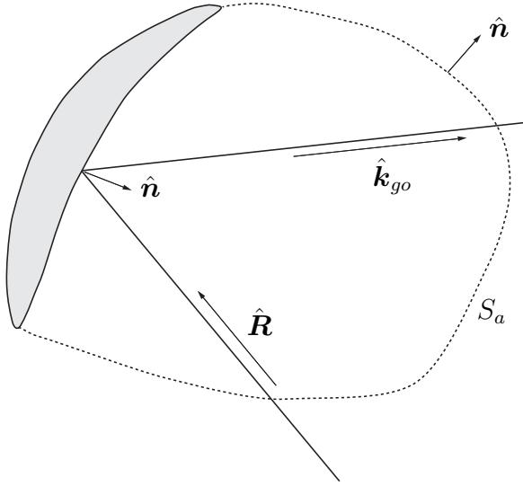
**Figur 3.16:** Konstruktion av det spridda fältet i geometrisk-optik-approximationen.
