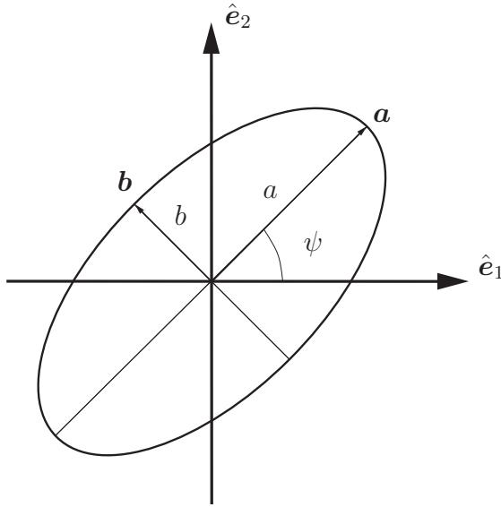
**Figur 1.11:** Polarisationsellipsen och definition av lutningsvinkeln  $\psi$ .
