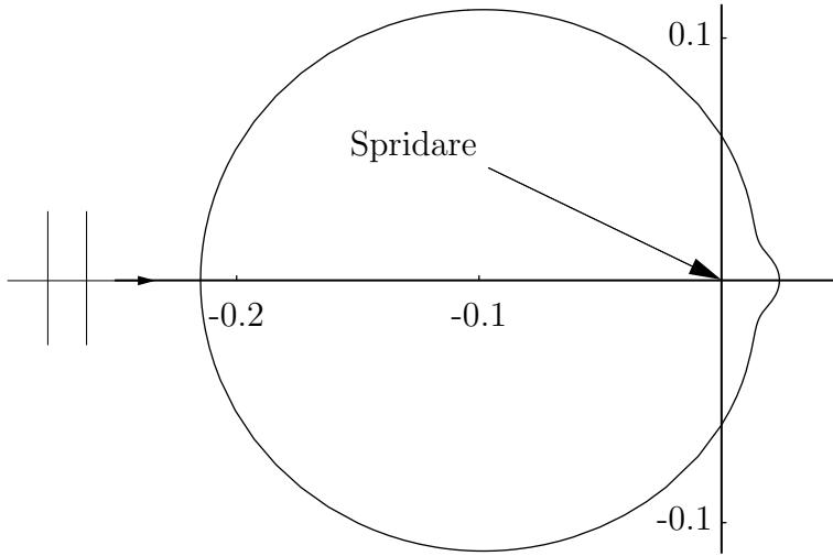
**Figur 4.4:** Strålningssdiagrammet  $f(\theta)$  för planvågsinfall mot en perfekt ledande sfär i långvågsgränsen,  $f(\theta) = \frac{3}{10\pi} \left( \frac{5}{8}(1 + \cos^2 \theta) - \cos \theta \right)$ . Normeringen är vald så att  $\iint_{\Omega} f(\theta) d\Omega = 1$ .
