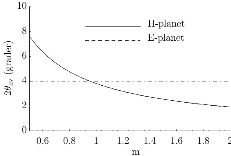
**Figur 3.20:** Lobbredd i grader som funktion av  $b$  och  $h$  för en cylindrisk reflektor i exempel 3.6. Beräkningarna är gjorda med geometrisk-optik-approximationen. I  $H$ -planet ( $x$ - $z$ -planet) bestäms  $b$  med  $h = F = 1$  m, medan i  $E$ -planet ( $y$ - $z$ -planet) bestäms  $h$  med  $b = F = 1$  m. Frekvensen  $f = 4$  GHz. Jämför figur 3.12 där beräkningarna är utförda med fysikalisk-optik-approximationen.
