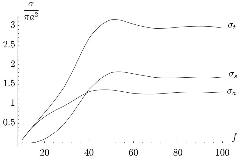
**Figur 4.9:** Det totala tvärsnittet  $\sigma_t$ , det totala spridningstvärsnittet  $\sigma_s$ , samt totala absorptionstvärsnittet  $\sigma_a$  för planvågsinfall mot en sfärisk vattendroppe ( $a = 1$  mm) som funktion av frekvensen  $f$  (GHz). Spridningstvärsnitten är skalade med  $\pi a^2$ .
