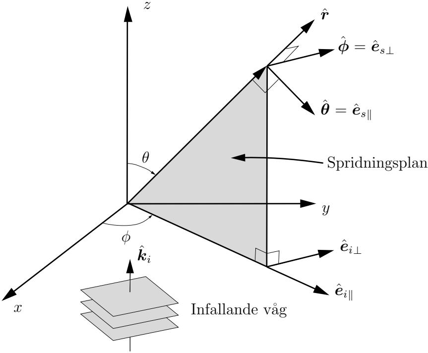
**Figur 3.4:** Definition av spridningsriktningar. I figuren är den infallande vågens utbredningsriktning vald till  $\hat{z}$ , vilket leder till att  $\hat{e}_{i\perp} = \hat{e}_{s\perp} = \hat{\phi}$ ,  $\hat{e}_{s\parallel} = \hat{\theta}$  och  $\hat{e}_{i\parallel} = \hat{\rho}$ .
