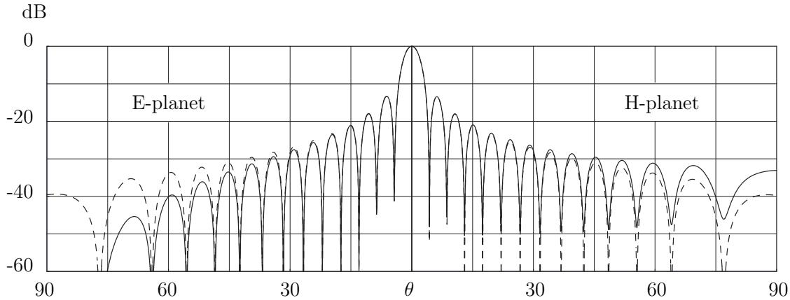
**Figur 3.13:** Jämförelse av fjärrfältsamplituden mellan fysikalisk-optik-approximationen och geometrisk-optik-approximationen i *E*-planet (*y*-*z*-planet) respektive *H*-planet (*x*-*z*-planet). Heldragen kurva representerar fysikalisk-optik-approximationen, se exempel 3.2, medan bruten kurva representerar geometrisk-optik-approximationen, se exempel 3.6.  $h = b = F = 1$  m, och frekvensen  $f = 4$  GHz.
