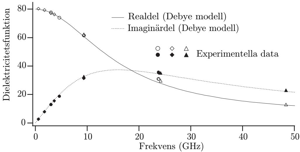
**Figur 1.7:** Experimentella data på dielektricitetsfunktionen  $\epsilon(\omega)$  som funktion av frekvensen  $\omega$  för vatten vid  $20^\circ$  i frekvensområdet upp till  $50\text{ GHz}$ . (Data är hämtade från Cock *et al.*, *Br. J. Appl. Phys.* **3**, 249 (1952), Grant *et al.*, *J. Chem. Phys.* **26**, 156 (1957), Lane *et al.*, *Proc. R. Soc. Lond.* **A213**, 400 (1952).)
