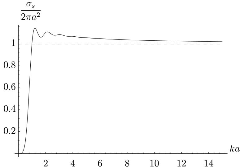
**Figur 4.2:** Det totala spridningstvärssnittet  $\sigma_s$  för planvågsinfall mot en perfekt ledande sfär som funktion av storleken  $ka$ . Notera att spridningstvärssnittet är normalerat med  $2\pi a^2$ .
