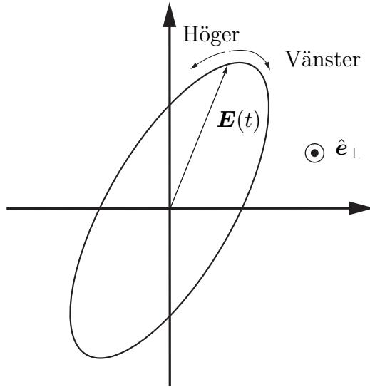
**Figur 1.5:** Polarisationsellipsen och definition av höger- och vänster-polarisation. Vektorn  $\hat{e}_\perp$  är enhetsvektorn  $\hat{e}$ :s komponent vinkelrätt mot planet i vilket  $\mathbf{E}(t)$  svänger.
