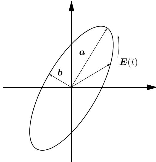
**Figur 1.4:** Polarisationsellipsen och dess halvaxlar  $\mathbf{a}$  och  $\mathbf{b}$ .
