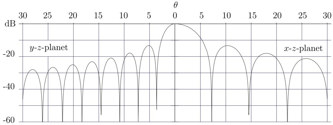
**Figur 3.19:** Differentiella spridningstvärsnittet för hörnreflektorn i exempel 3.5. Det differentiella spridningstvärsnittet normerat med  $(kbh/2\pi)^2$ ,  $kb = 50$ ,  $kh = 100$ .
