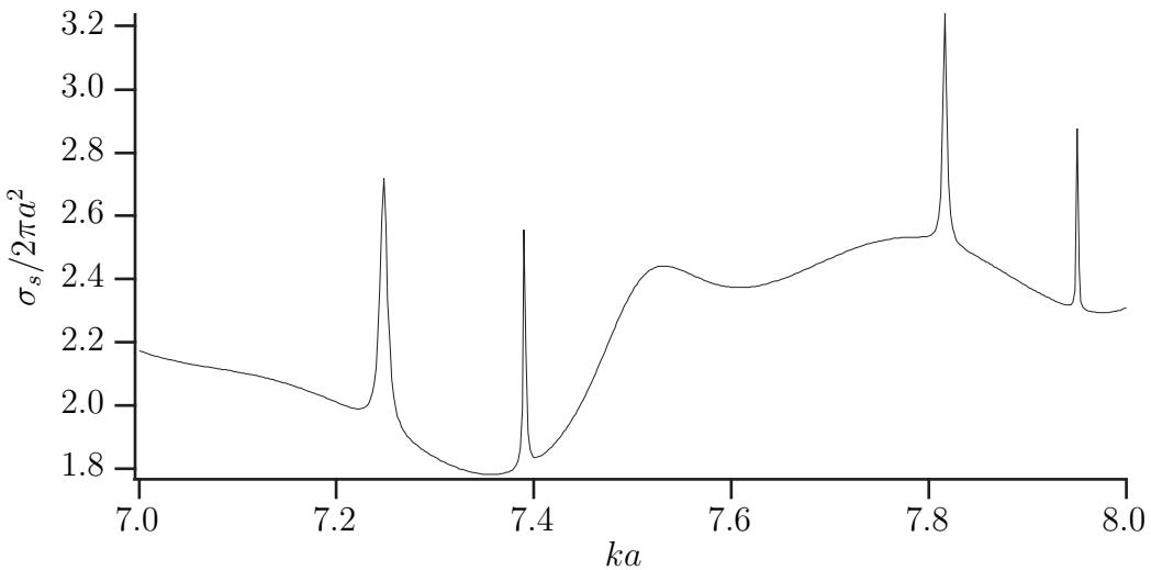
**Figur 3.27:** Det totala spridningstvärsnittet  $\sigma_s/\pi a^2$  för en dielektrisk sfär. Sfärens materialparametrar är  $\epsilon = 4$  och  $\mu = 1$  (relativa värden jämfört med omgivande material). Notera normeringen.
