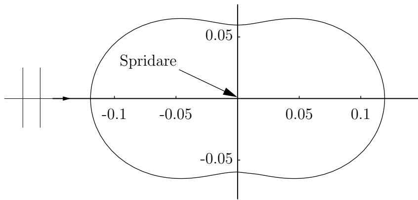
**Figur 4.10:** Strålningsdiagrammet för planvågsinfall mot en dielektrisk sfär i långvågsgränsen,  $f(\theta) = \frac{3}{16\pi}(1 + \cos^2 \theta)$ . Normeringen är vald så att  $\iint_{\Omega} f(\theta) d\Omega = 1$ .
