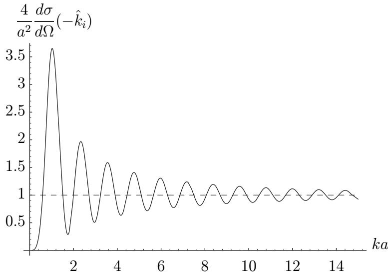
**Figur 4.3:** Det differentiella spridningstvärsnittet  $\frac{d\sigma}{d\Omega}(\hat{r})$  i bakåtriktningen  $\hat{r} = -\hat{k}_i$  för en perfekt ledande sfär som funktion av storleken  $ka$ . Notera normeringen, som i detta fall är  $\pi a^2/4\pi = a^2/4$ .
