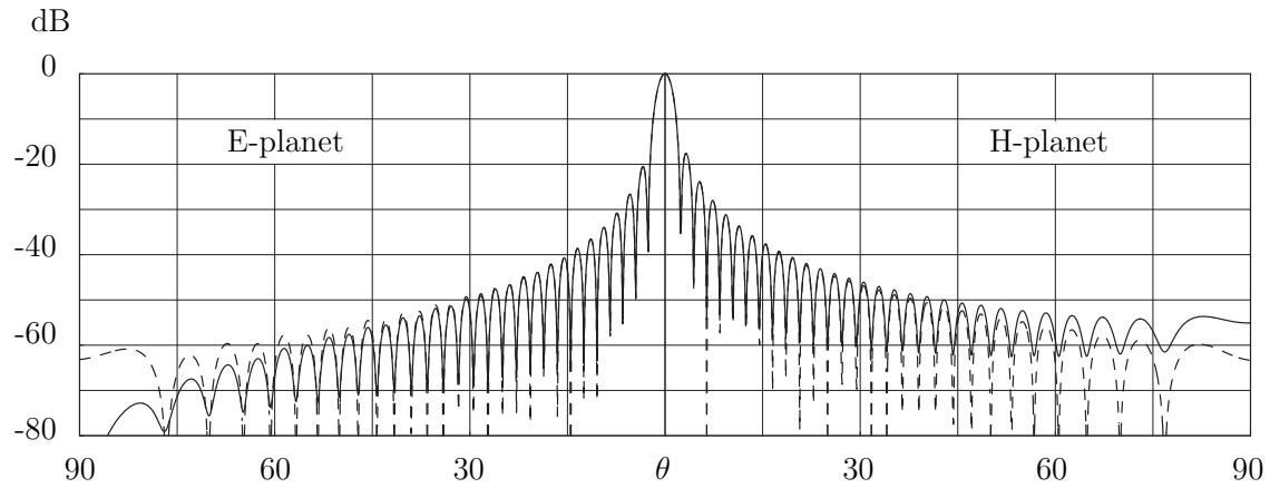
**Figur 3.15:** Jämförelse mellan fysikalisk-optik-approximationen och geometrisk-optik-approximationen i  $H$ -planet ( $x$ - $z$ -planet eller  $\phi = 0$ -planet) och  $E$ -planet ( $y$ - $z$ -planet eller  $\phi = \pi/2$ -planet). Heldragen kurva representerar fysikalisk-optik-approximationen, se exempel 3.3, medan bruten kurva representerar geometrisk-optik-approximationen, se exempel 3.7.  $a = 0.4$  m,  $F = 0.5$  m, och frekvensen  $f = 11$  GHz.
