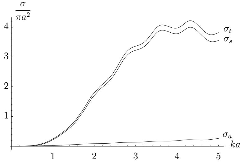
**Figur 4.8:** Det totala tvärsnittet  $\sigma_t$ , det totala spridningstvärsnittet  $\sigma_s$ , samt totala absorptionstvärsnittet  $\sigma_a$  för planvågsinfall mot en dielektrisk sfär som funktion av storleken  $ka$ . Sfärens material har parametrarna  $\epsilon_1/\epsilon = (1.5+i0.01)^2$ , samt  $\mu_1/\mu = 1$ . Spridningstvärsnitten är skalade med  $\pi a^2$ .
