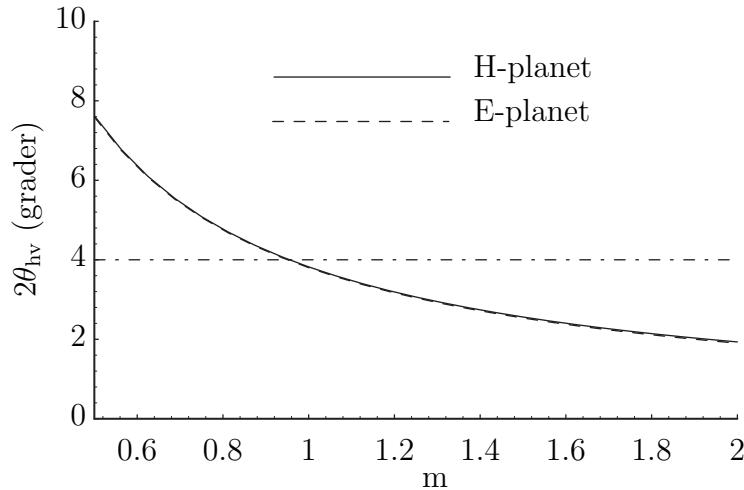
**Figur 3.12:** Lobbredd i grader som funktion av  $b$  och  $h$  för en cylindrisk reflektor i exempel 3.2. Beräkningarna är gjorda med fysikalisk-optik-approximationen. I  $H$ -planet ( $x$ - $z$ -planet) bestäms  $b$  med  $h = F = 1$  m, medan i  $E$ -planet ( $y$ - $z$ -planet) bestäms  $h$  med  $b = F = 1$  m. Frekvensen  $f = 4$  GHz. Jämför figur 3.20 där beräkningarna är utförda med geometrisk-optik-approximationen.
