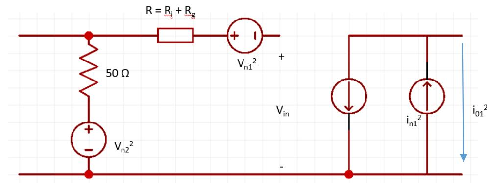
$$i_{01} = i_{n1} + (v_{n1} + v_{n2}) * g_m$$
