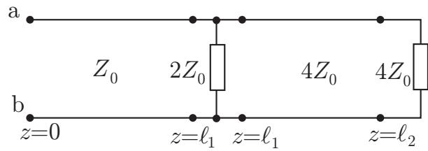
Lasten till  $4Z_0$  ledningen är anpassad vilket ger reflektionsfaktorn  $\Gamma_2 = 0$ . Det ger en parallellkoppling mellan  $2Z_0$  och  $4Z_0$ ,
