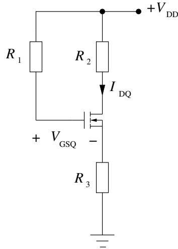
Eftersom ingen ström går genom  $R_1$  är potentialen vid gate lika med  $V_{DD}$ , medan potentialen vid source är  $R_3 I_{DQ}$ . Detta ger spänningen mellan gate och source
