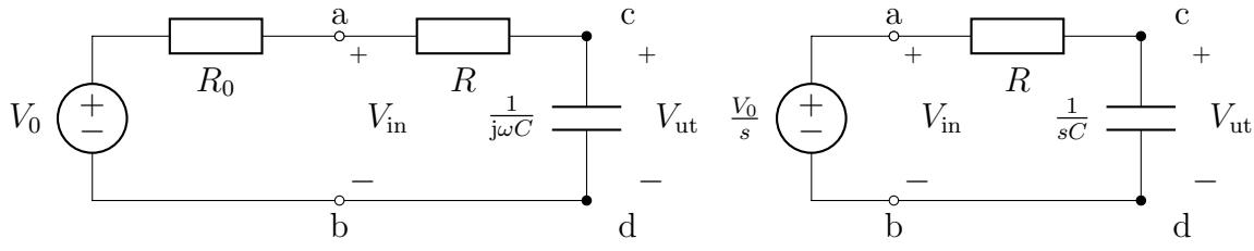
a) tidsharmonisk signal så transformera till frekvensdomän  $v_s(t) = \text{Re}\{V_0 e^{j\omega t}\} \rightarrow V_0$ . Spänningarna bestäms med spänningsdelning (eller bestäm först strömmen)
