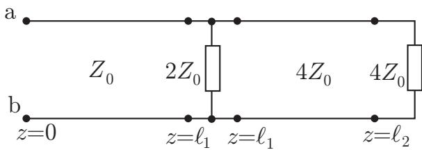
Bestäm impedansen mellan nodparet ab. Kopplingen består av två transmissionsledningar med karakteristiska impedanser  $Z_0$  och  $4Z_0$ .
