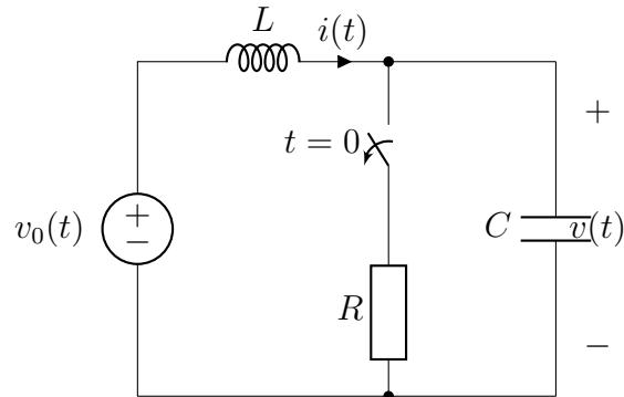
Spänningsskällan ger en likspänning  $v_0(t) = V_0$ . Strömbrytaren öppnas vid tiden  $t = 0$ .
