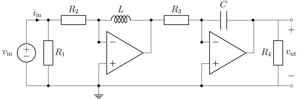
Bestäm överföringsfunktionen  $V_{ut}/V_{in}$  för kopplingen i figuren. Resistanserna  $R_1, \dots R_4$ , kapacitansen  $C$  och induktansen  $L$  är kända och operationsförstärkarna kan anses vara idealala.
