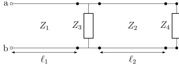
Kopplingen består av två luftfylda transmissionsledningar med karakteristiska impedanser  $Z_1$  och  $Z_2$  med vardera längd  $\ell_1$  och  $\ell_2$ . Transmissionsledningarna är ihopkopplade med kretselement med impedanser  $Z_3$  och  $Z_4$ . Bestäm inimpedansen mellan nodparet ab då  $\ell_1 = \lambda/4$  och  $Z_4 = Z_2$ .
