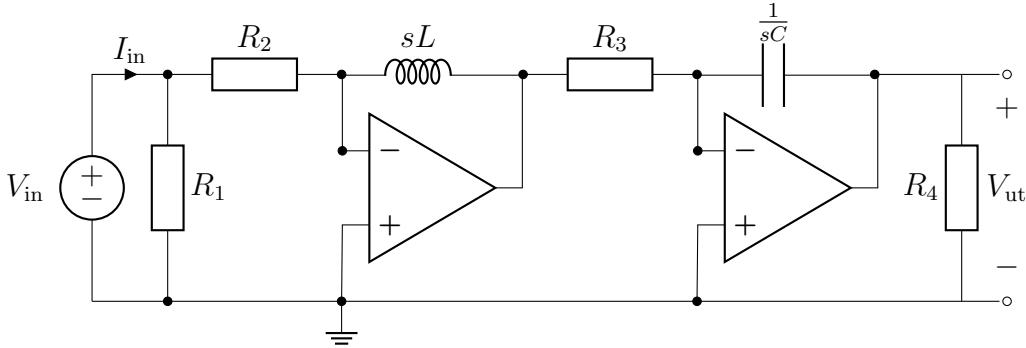
Idealala operationsförstärkare med negativ återkoppling ger att ingångsspänningen på operationsförstärkarna är noll och därmed har de också potential lika med noll (jordade).
