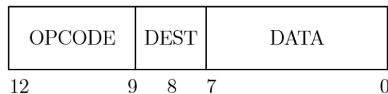
Figur 5.4: Varje instruktion, I , består av 13 bitar. Bit 12-9 är instruktionens operationskod, bit 8 destinationsbiten och bit 7-0 är data. Observera att bit 0 är den minst signifikanta.
