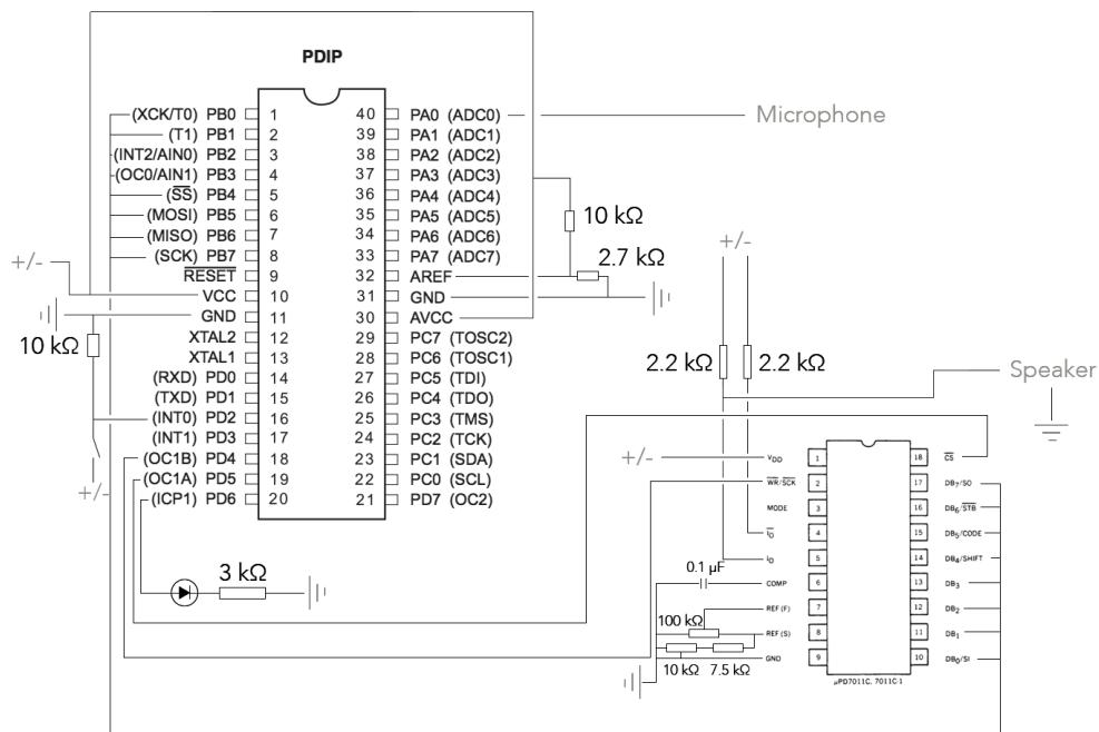
Figur 1: Konstruktionens kopplingsschema
