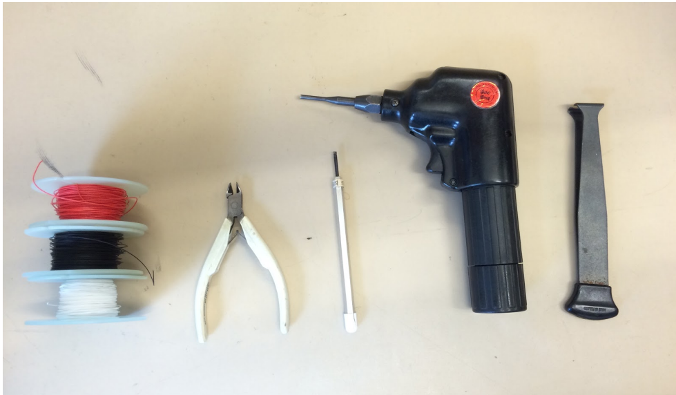
Bild 1. Bild över verktyg och kablar som användes. F.v.: kablar (röd, svart och vit), tång, verktyg som användes vid felkoppling, verktyg som användes vid "spänning" vid koppling och skalningsverktyg.
