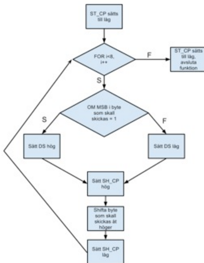
Flödesschema: Interfacerutin för 74HC595 .
