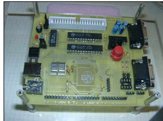
Abb. 33, 34 – AN2131QC-Entwicklungsboard in Ansicht von oben (links) und unten (rechts)
