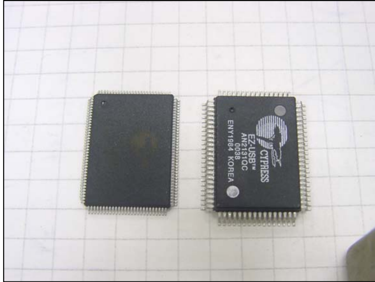
Abb.39- Die Chips CY7C68013 (li.) und AN22131QC (re.) im Größenvergleich
