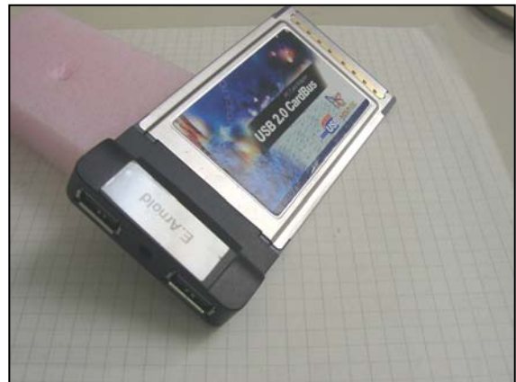
Abb. 1,2 – PCI-Einsteckkarte und PCMCIA-Karte (rechts) für die Nachrüstung von USB 2.0-Schnittstellen
