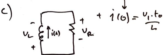
$$\text{KVL: } V_L + V_R = 0 \quad V_R = i(t) \cdot R \quad \Rightarrow \quad L \cdot \frac{di}{dt} + i \cdot R = 0$$
