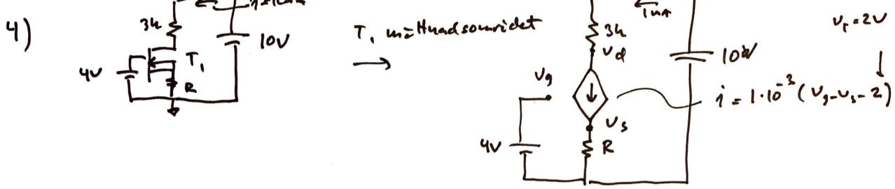
a)  $1 \cdot 10^{-3} = 1 \cdot 10^{-3} (V_{gs} - 2) \Rightarrow V_{gs} = 3V$
