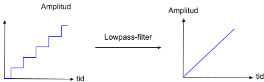
Figur 2: Den analoga signalen är först uppdelad i 256 nivåer men efter att ha passerat ett lowpass-filter jämnas signalen ut.
