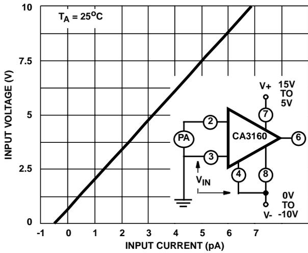
FIGURE 23. INPUT CURRENT vs COMMON MODE VOLTAGE
