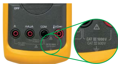
Använd mätare med de här markeringarna: 1000 V KAT III eller 600 V KAT IV
